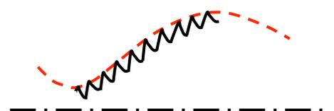
Signal démodulé (assez proche du signal modulant mais avec les défauts de démodulation)
