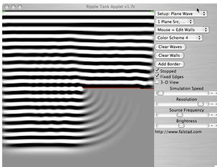
Diffraction d'une onde à deux dimensions par un obstacle.
