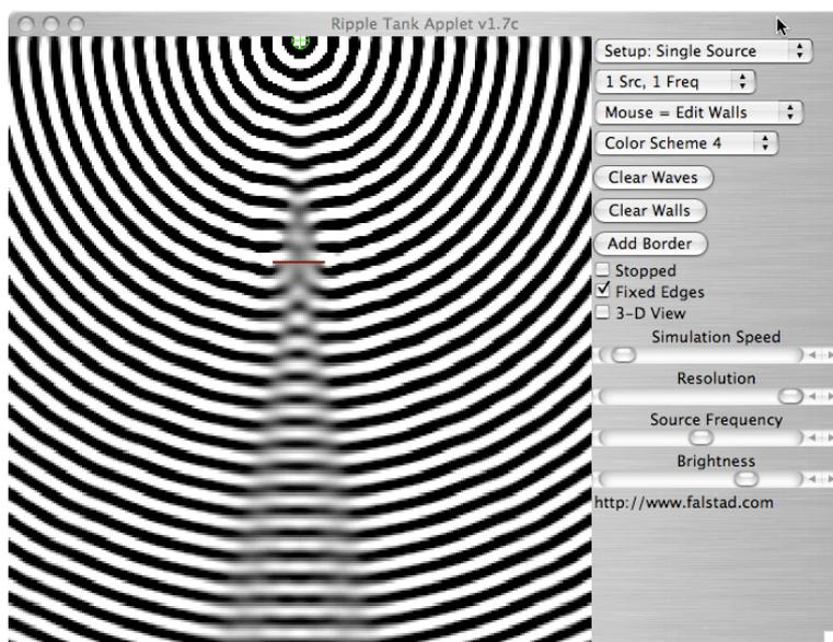
On observe une onde diffractée par la zone d'ombre de l'obstacle.
