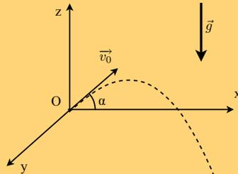
On utilise un repère  $(O, \vec{i}, \vec{j}, \vec{k})$  tel que l'origine O coïncide avec la position du centre d'inertie de la bille à  $t = 0$  s. L'axe  $(O, \vec{k})$  est dirigé vers le haut.
